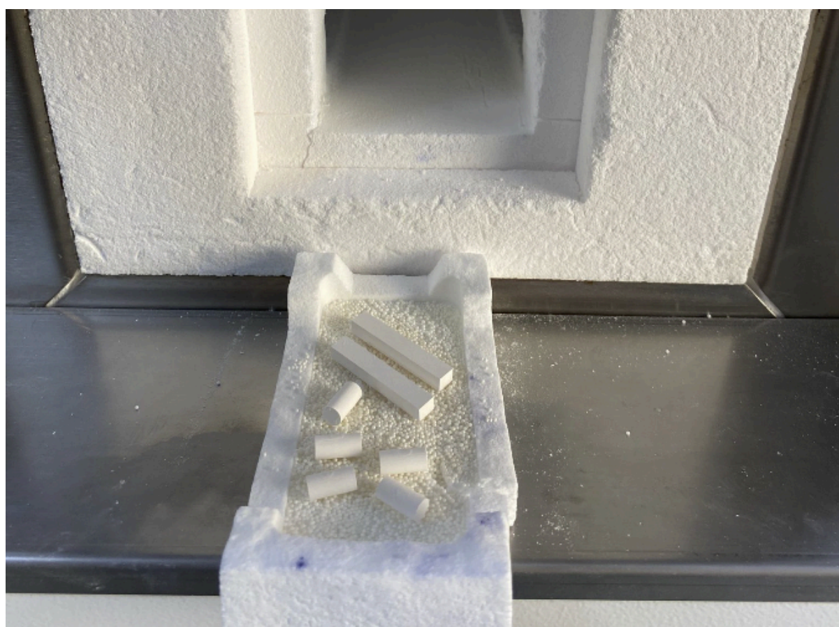
Rycina 7. Próbkki przed umieszczeniem w piecu do synteryzacji.
