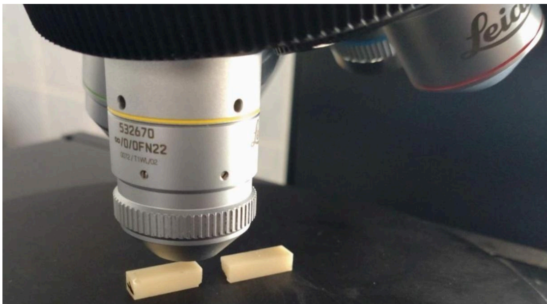
Rycina 14. Pomiar SGP powierzchni próbki w pobliżu przelomu.
