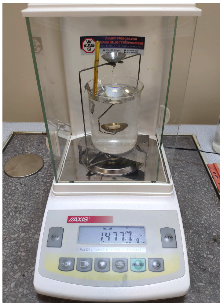
Rycina 11. Ustawienie układu do mierzenia gęstości.
