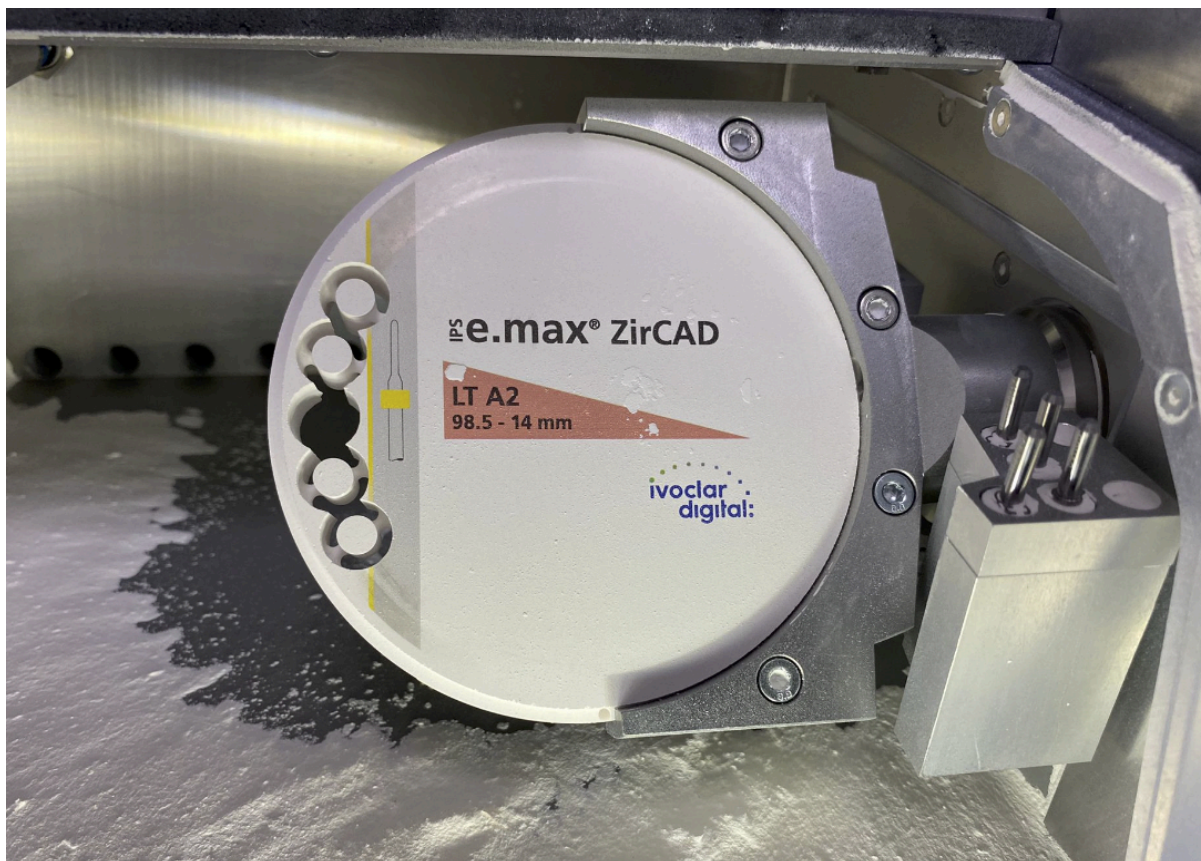
Rycina 6. Frezarko-szlifierka Z4 frezująca próbki z krążka.
