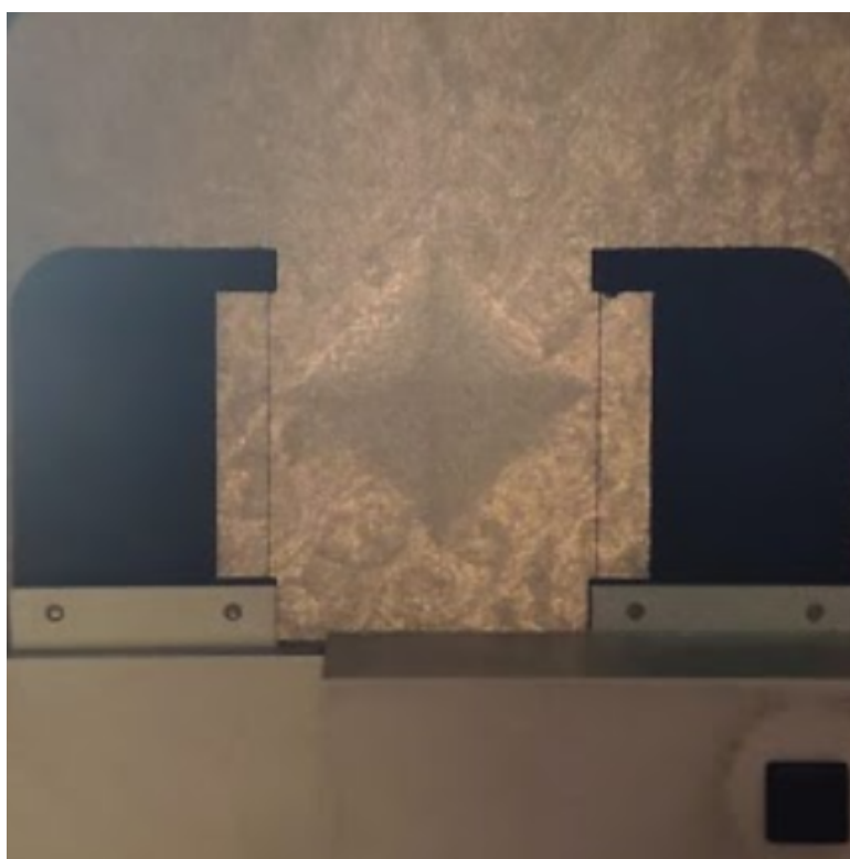
Rycina 13. Przekrój wgniecenia wykonanego przez twardościomierz.
