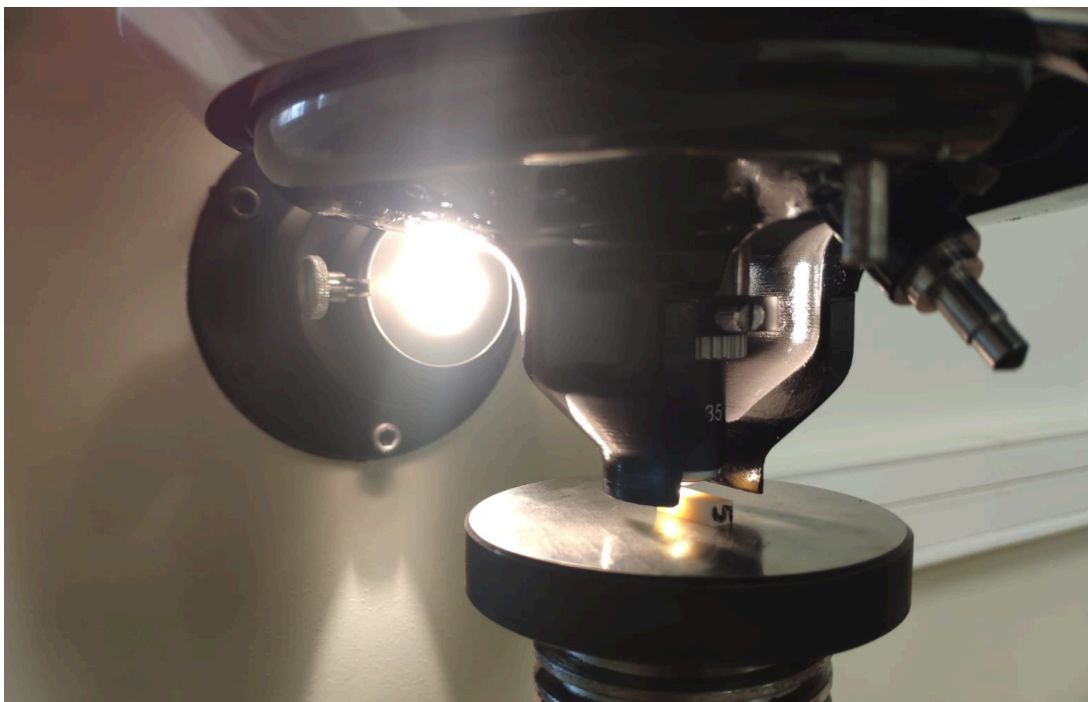
Rycina 12. Ustawienie układu do mierzenia twardości wg Vickersa.
