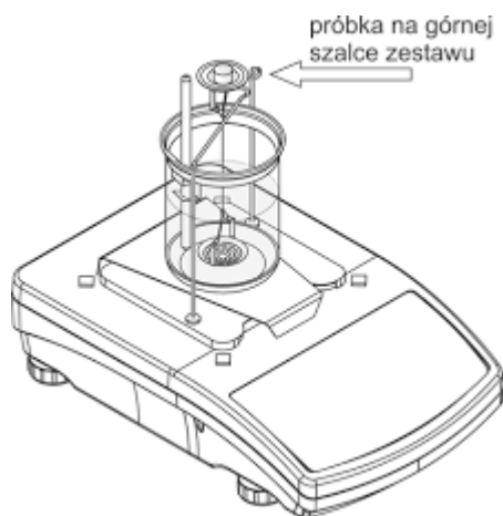
Rycina 18. Waga hydrostatyczna firmy RADWAG [102]
