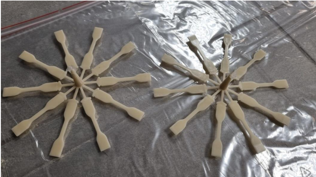
Rycina 13. Wypraski w kształcie rozety połączone kanałem odlewniczym
