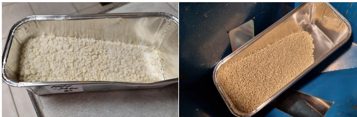
Rycina 11. Rozdrobniony i przygotowany materiał: a) acetal; b) BioHPP
