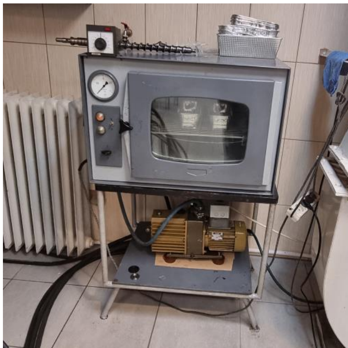
Rycina 12. Suszarka, w której materiały są przygotowywane do wtrysku
