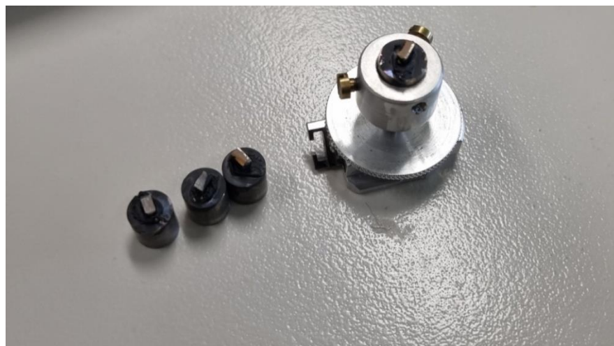
Rycina 17. Po 2 próbki z tworzywa acetalowego i BioHPP pokryte cienką warstwą napyłonego złota w celu zwiększenia przewodzenia
