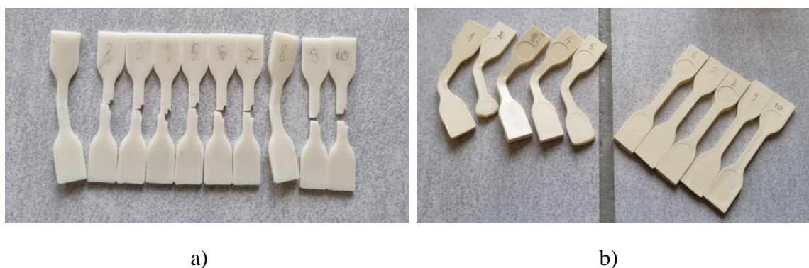
Rycina 49. Próbki obu materiałów po badaniu udarności: Biocetal (a) oraz BioHPP (b)
