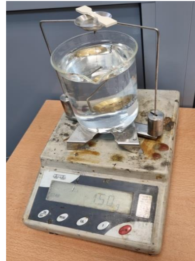
Rycina 18. Waga hydrostatyczna firmy RADWAG [102]
