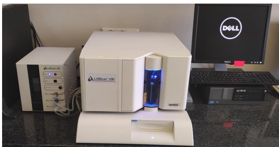
Ryc. 14. Stanowisko do odczytu testów wykonanych metodą Luminex (od lewej pompa, aparat LABScan 100 i komputer z oprogramowaniem do odczytu)
