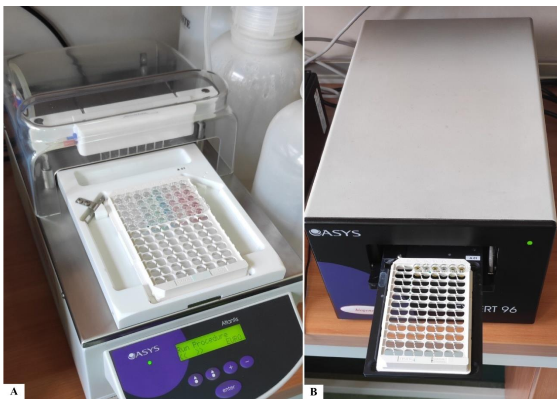
Ryc. 15. Automatyczna płuczka do płukania testów ELISA (A) i czytnik do odczytu testów ELISA (B)
