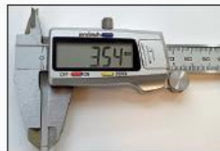
Ryc. 5. Długość odlamanych fragmentów pilników mierzono za pomocą elektronicznej suwmiarki (Magnusson, London, Wielka Brytania).
