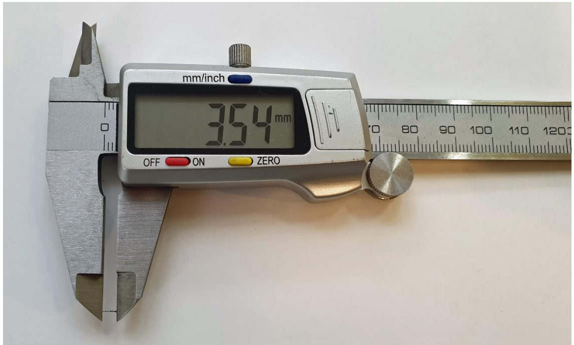
Ryc. 4. Długość odłamanych fragmentów pilników mierzono za pomocą elektronicznej suwmiarki MS32 (Magnusson; Londyn, Wielka Brytania).
