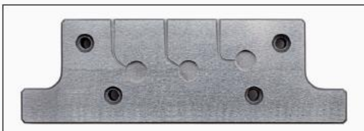
Ryc. 1. Urządzenie ze stali nierdzewnej zawierające sztuczne kanały do przeprowadzania testów zmęczeniowych pilników endodontycznych.
