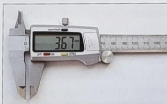
Ryc. 4. Długość odlamanych fragmentów pilników mierzono za pomocą elektronicznej suwmiarki (Magnusson; London, Wielka Brytania).
